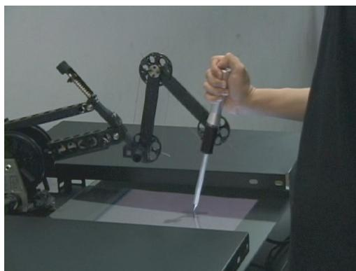
図 E.1 力覚提示装置 -Smart Tool-
