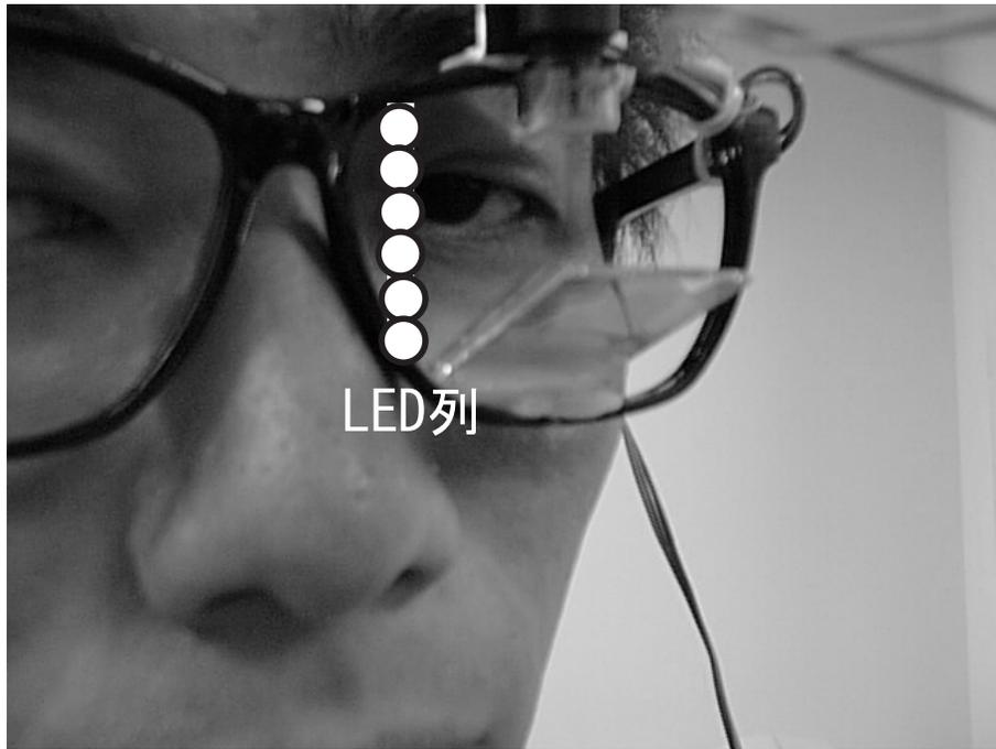
図 4.8 ウェアラブルデバイスとしての実装例 (概念図)
