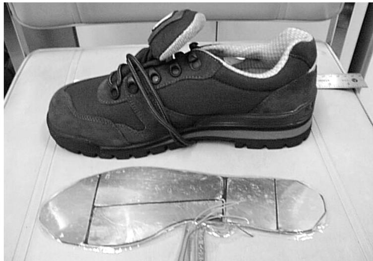
図 F.9 靴底圧力センサ
